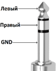
Рисунок 4 – Цоколёвка разъёма Jack 6.3 mm 3-pin
