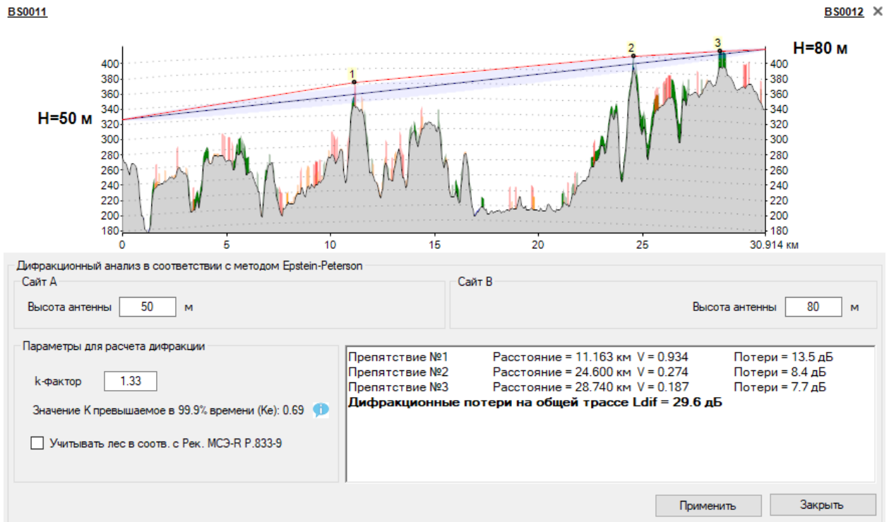
Рисунок 24. Анализ дифракционных потерь по методу Эпштейна-Петерсона
